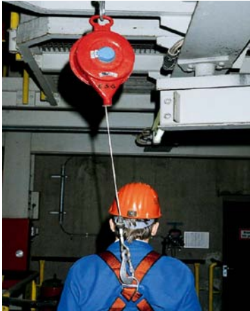
Bild 6: Beispiel eines Auffangsystems mit Höhensicherungsgerät
