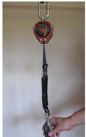
Bild 19: Höhensicherungsgerät mit Verbindungsmittel aus Gurtband
